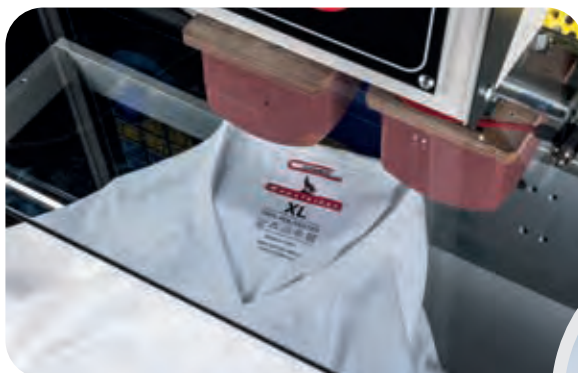
Tamponiarki wyspowe posiadają specjalny stół detalu, który ułatwia nadruk na tkaninach
